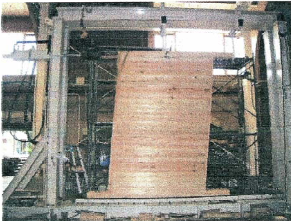
図-4 床組面内せん断試験における終局時の性状
